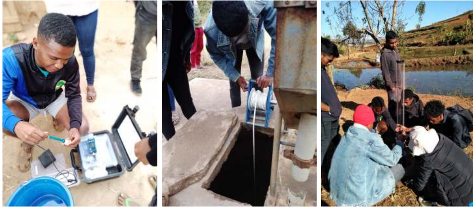
FIGURE 2.3 – Stage de terrain en Itasy. mesures de piézométrie, de pH et d'infiltration.
